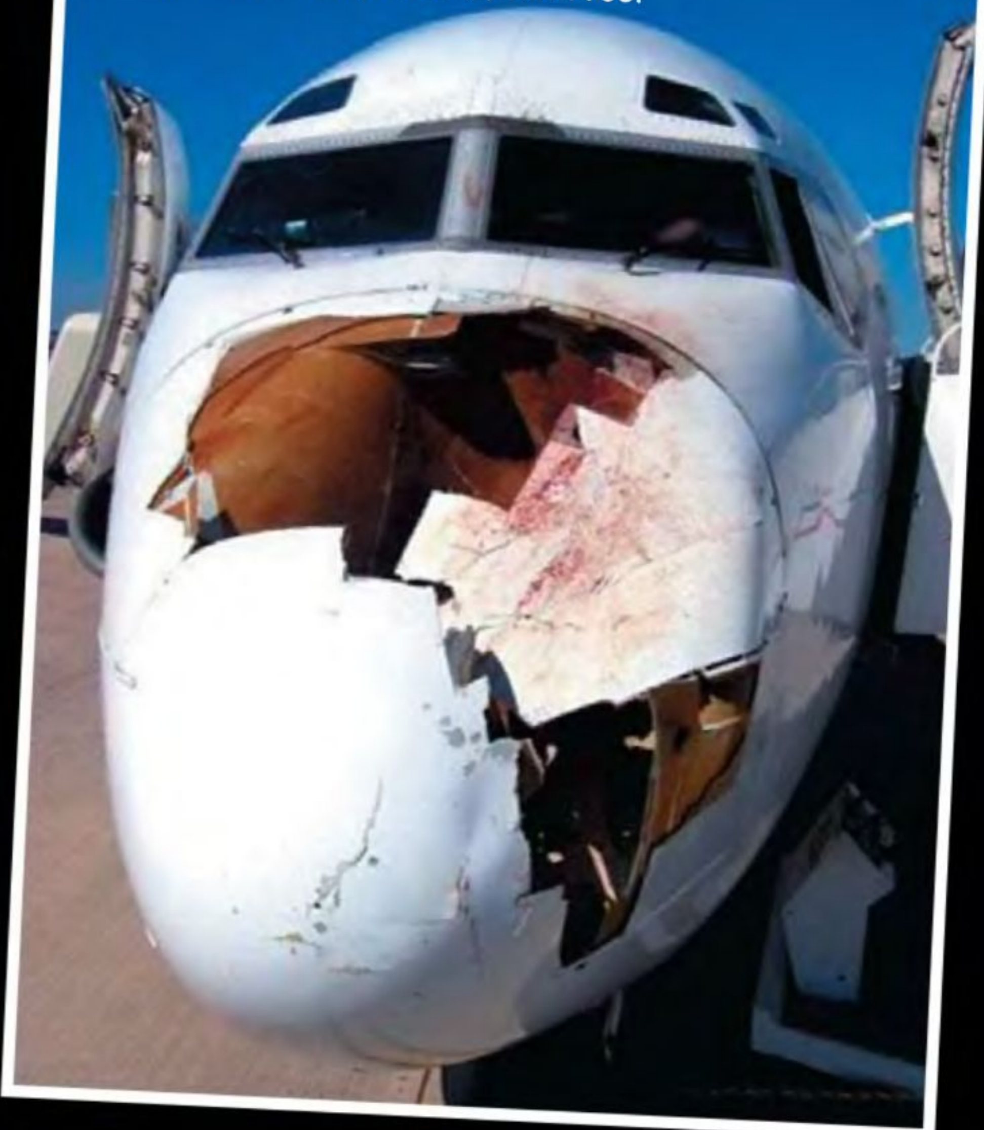
Результат лобового столкновения А – 320 с крупной птицей. США, 2004 год.
